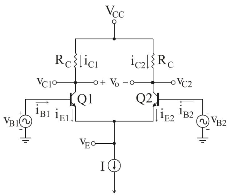
$$i_{E1} = \frac{I}{1 + e^{(v_{B2} - v_{B1})/V_T}}$$
