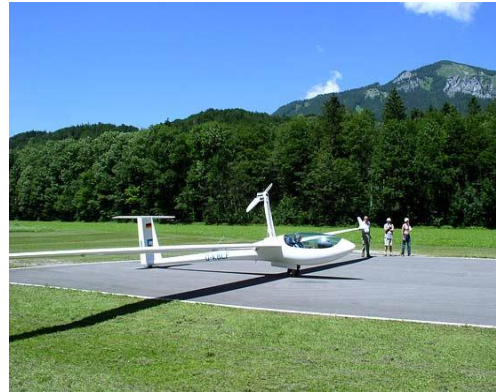
Antares 20E 42kW BLDC Propulsion
